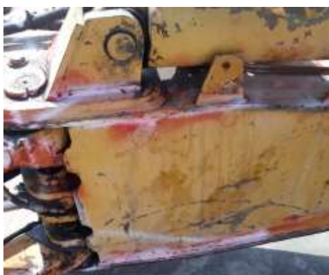
Foto5: BRAZOS PARTE INTERNA RH Y LH , SIN INDICACIONES. BASE DE CILINDROS SIN GRIETAS
