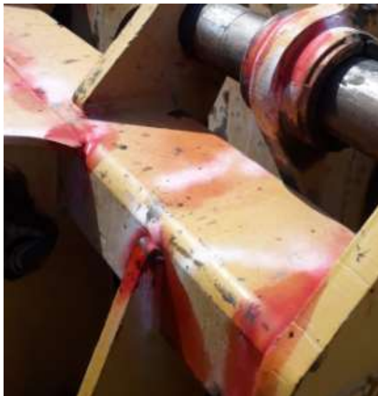
Foto7: ZONA DE ACOUPLE ARM LIFT, SIN INDICACIONES
